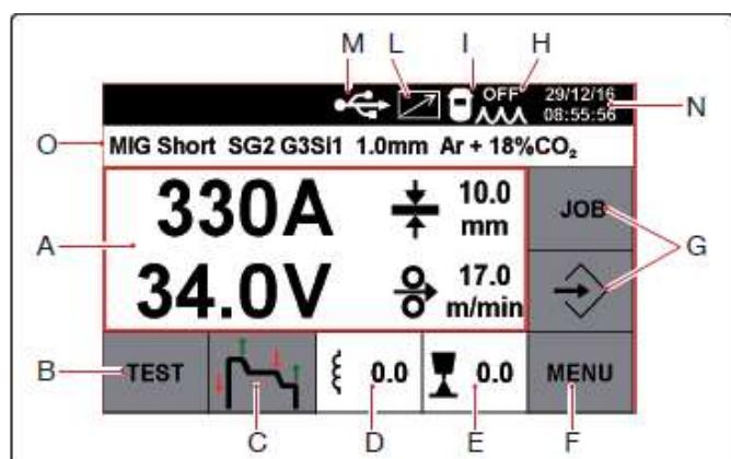
**A** На экране отображен сварочный ток в амперах, сварочное напряжение в вольтах, рекомендуемая толщина в мм и скорость подачи сварочной проволоки в метрах/минуту. Во время сварки на дисплее постоянно отображаются значения тока и напряжения, после завершения сварки отображается последнее значение в амперах и вольтах вместе со словом HOLD (УДЕРЖАНИЕ).
