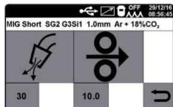
Если вы нажмете кнопку (анализ газа), газ будет выходить из сварочной горелки в течение некоторого периода времени, который регулируется с помощью кнопки 30; значение регулируется с помощью ручки 2, от 1 до 60 секунд. Для прерывания выпуска газа нажмите кнопку снова. Когда вы нажмете
