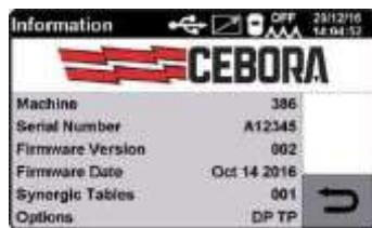
Когда аппарат включается, в течение какого-то времени на дисплее отображаются: номер артикула аппарата, серийный номер, версия микропрограммного обеспечения, дата разработки микропрограммного обеспечения и номер выпуска таблицы синергических кривых и дополнительные возможности источника электропитания.
