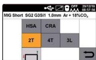
Когда параметр **HSA** будет активирован, оператор сможет отрегулировать **Start current** (Пусковой ток) от 10 до 200% от значения сварочного тока.
