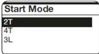
Режим **3L** Особенно хорошо подходит для сваривания алюминия. Доступно 3 тока, которые могут использоваться при сварке посредством кнопки пуска на сварочной горелке. Установлены следующие значения тока и времени восхождения:
