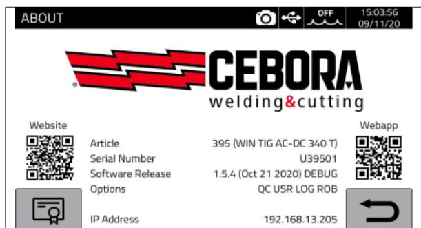
Al encendido, el display visualiza durante 5 segundos todos los datos concernientes al artículo de la máquina, la matrícula, la versión del software, la fecha de actualización software, las opciones instaladas y la dirección IP.
