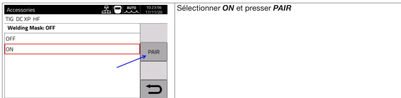
Si le masque est reconnu, l'icône apparaît dans la section **S** de l'écran . Dès que le courant de soudage commence à circuler sur la pièce, le masque s'obscurecit automatiquement. Pour vérifier son bon fonctionnement, il suffit de presser la touche « OBSCURCIR » sur l'écran, et de vérifier que la vitre du masque s'obscurecit.
