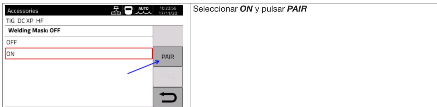
Si se reconoce la máscara, en la sección **S** del display aparece el icono . Cada vez que comienza a circular la corriente de soldadura por la pieza, la máscara se oscurece automáticamente. Para probar la función es suficiente pulsar el botón “OSCURAR” en pantalla y comprobar que se oscurezca el cristal de la máscara.
