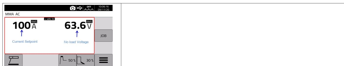
En el proceso MMA AC la frecuencia de la corriente de salida es de 50Hz y la forma de onda de salida es cuadrada.
