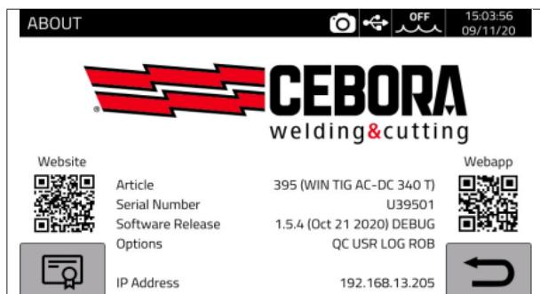
Nach dem Einschalten zeigt das Display für fünf Sekunden die folgenden Informationen an: die Artikelnummer des Geräts, die Seriennummer, die Version der Software, das Datum der Aktualisierung der Software, die installierten Optionen und die IP-Adresse.
