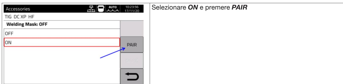
Se la maschera viene riconosciuta allora nella sezione **S** del display appare l'icona . Ogni qual volta che la corrente di saldatura inizierà a circolare sul pezzo di saldatura la maschera si oscura automaticamente. Per verificare la funzionalità è sufficiente premere il tasto “OSCURA” sul display verificando che il vetro della maschera si oscura.
