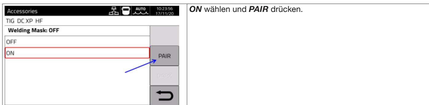
Wenn der Schweißhelm erkannt wird, erscheint im Bereich **S** des Displays das Symbol . Immer wenn der Schweißstrom im Werkstück zu fließen beginnt, wird die Schutzscheibe des Schweißhelms automatisch abgedunkelt. Zum Prüfen der Funktion muss man nur die Taste „OSCURA“ auf dem Display drücken und kontrollieren, ob sich das Glas der Maske verdunkelt.
