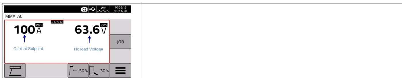
Dans le procédé MMA AC, la fréquence du courant de sortie est de 50 Hz et la forme d'onde de sortie est carrée.
