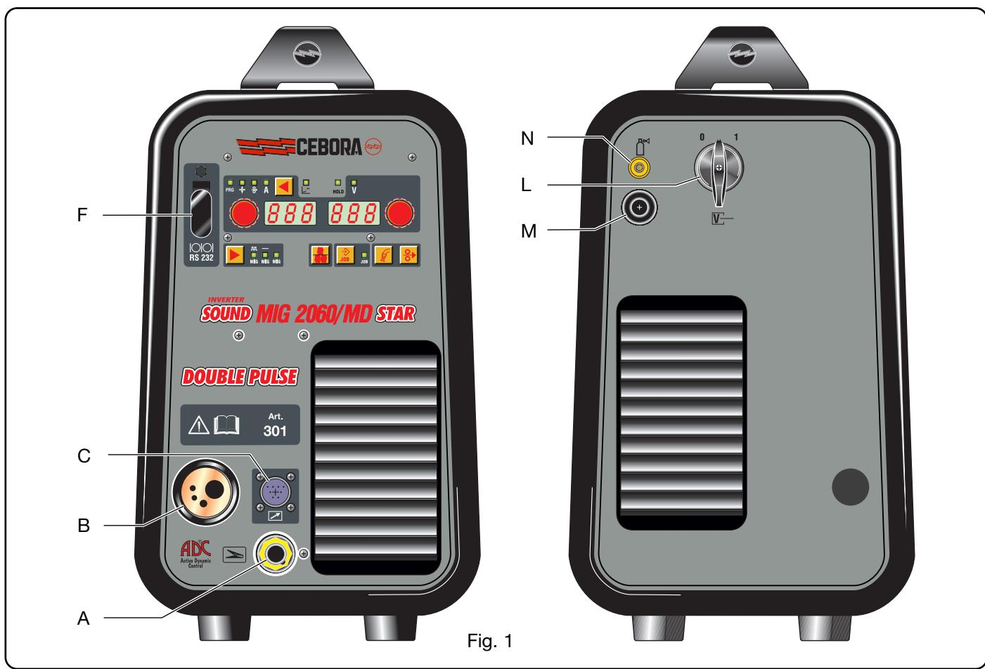
**F - Kontaktdon:** Kontaktdon av typ DB9 (RS 232), används för att uppdatera mikroprocessorns program.
