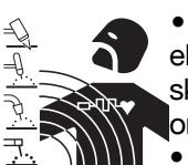
• Strøm, der løber igennem en leder, skaber elektromagnetiske felter (EMF). Svejse- og skærerstrøm skaber elektromagnetiske felter omkring kabler og strømkilder.
