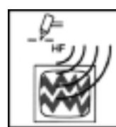
• La haute fréquence (HF) peut interférer avec la radionavigation, les services de sécurité, les ordinateurs, et en général avec les équipements de communication
