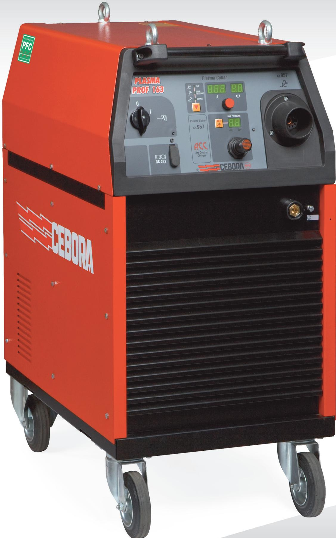
Трёхфазный источник чопперного типа “chopper”, работающий с различными напряжениями **PLASMA PROF 163 ACC**, арт. 957, благодаря высокой мощности (160А при 40%), а также использованию новой горелки CP161, обеспечивают выдающуюся производительность при резке металла: рекомендуемая толщина для лучшего качества резки и производительности равна 40 мм; максимальная толщина 45 мм и предельная толщина 50 мм.
