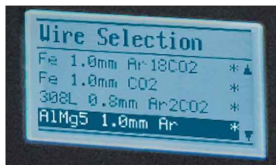
нержавеющей стали и CuSi3 (см. Фотографию № 2). Панель управления с технологией OLED выводит пользователю информацию о виде проволоки и типе газа, ток и толщину, напряжение и скорость проволоки на трех строчках.
