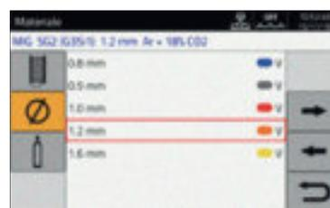
Установка присадочной проволоки с индикацией типа барабана
