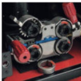
Компактное быстросъемное устройство подачи проволоки с 4 барабанами и с роликами (диам. 37 мм), легко идентифицируемые благодаря системе с цветным кодированием на основании диаметров
