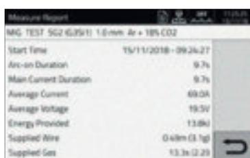
Отчет об измерениях после каждого сварочного прутка
