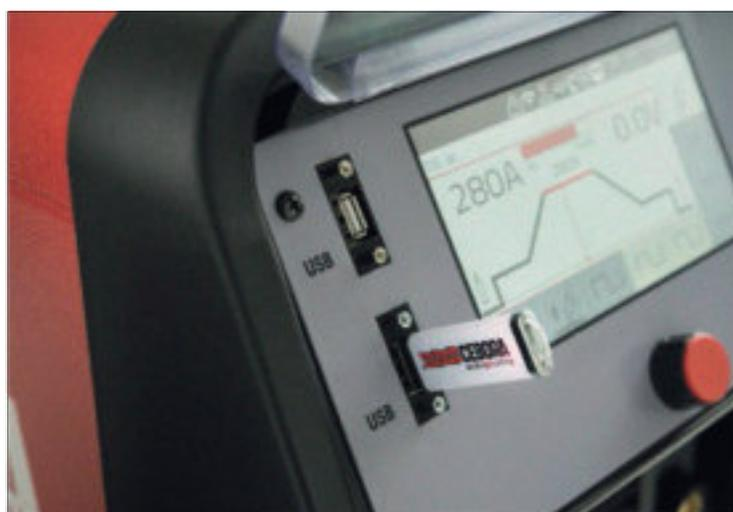
USB-устройство для обновления программного обеспечения
