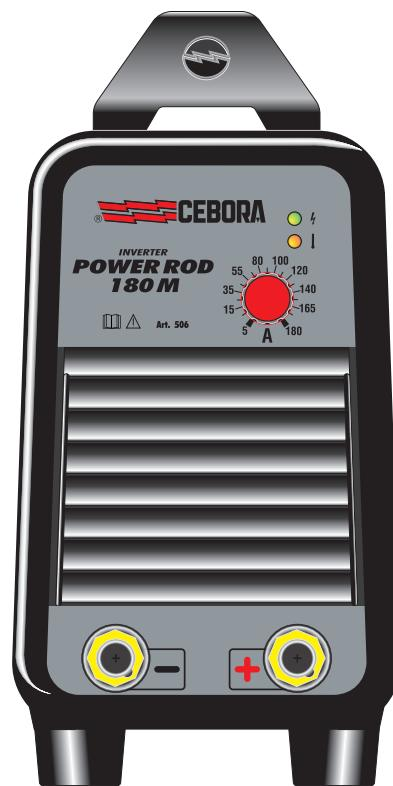
Il generatore inverter MMA **POWER ROD 180 M** (art. 506) è adatto alla saldatura in MMA di tutti gli elettrodi rutilici, basici AWS 7018, in acciaio inossidabile ed in alluminio.
