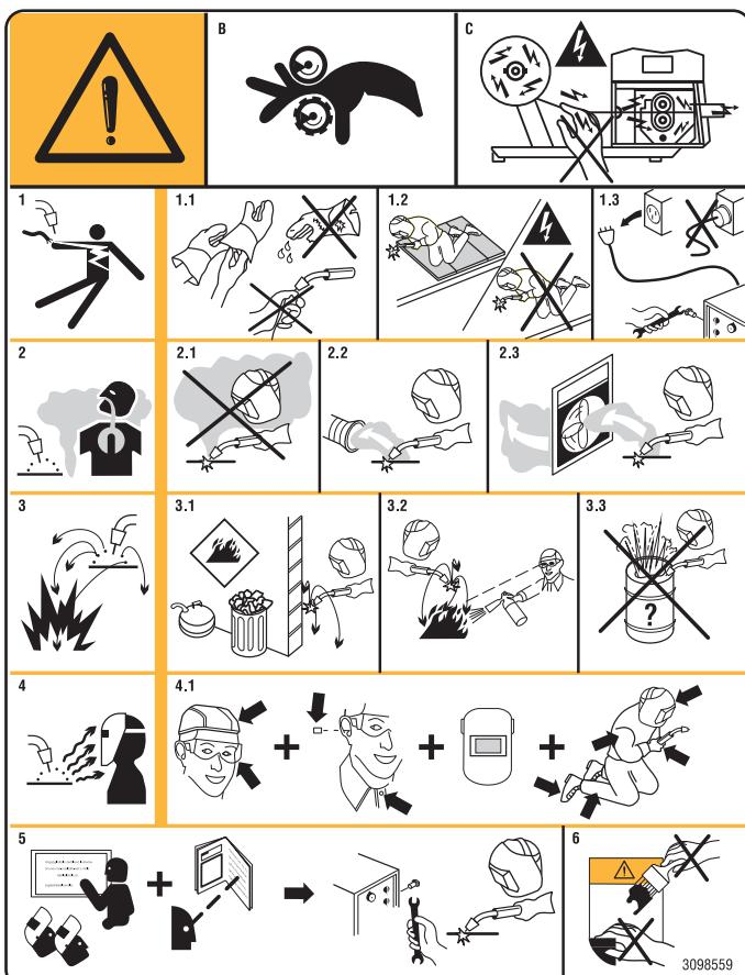
3. Die beim Schweißen entstehenden Funken können Explosions oder Brände auslösen.
