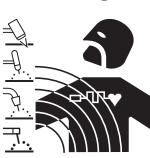
• Der elektrische Strom, der durch einen beliebigen Leiter fließt, erzeugt elektromagnetische Felder (EMF). Der Schweiß- oder Schneidstrom erzeugt elektromagnetische Felder um die Kabel und die Stromquellen.
