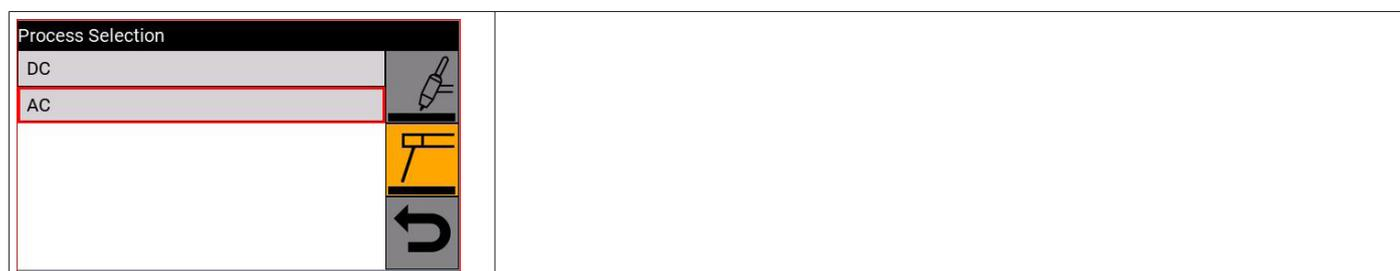
Dans le procédé MMA AC, la fréquence du courant de sortie est de 50 Hz et la forme d'onde de sortie est carrée. La fréquence et la forme d'onde sont fixes et non variables, contrairement au procédé TIG AC.
