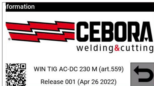
Al encendido, el display visualiza durante unos segundos todos los datos concernientes el artículo de la máquina, la matrícula, la versión del software y la fecha de actualización software. Sucesivamente, en el display aparece la pantalla principal con la configuración de fábrica
