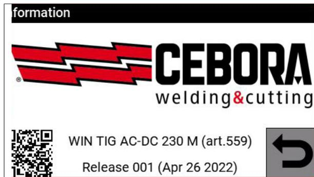
Nach dem Einschalten zeigt das Display für einige Sekunden die folgenden Informationen an: Artikelnummer des Geräts, Seriennummer, Softwareversion und Datum der Aktualisierung der Software.
