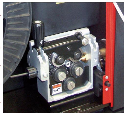
Foto del vano bobina con trainafilo a 4 rulli.
