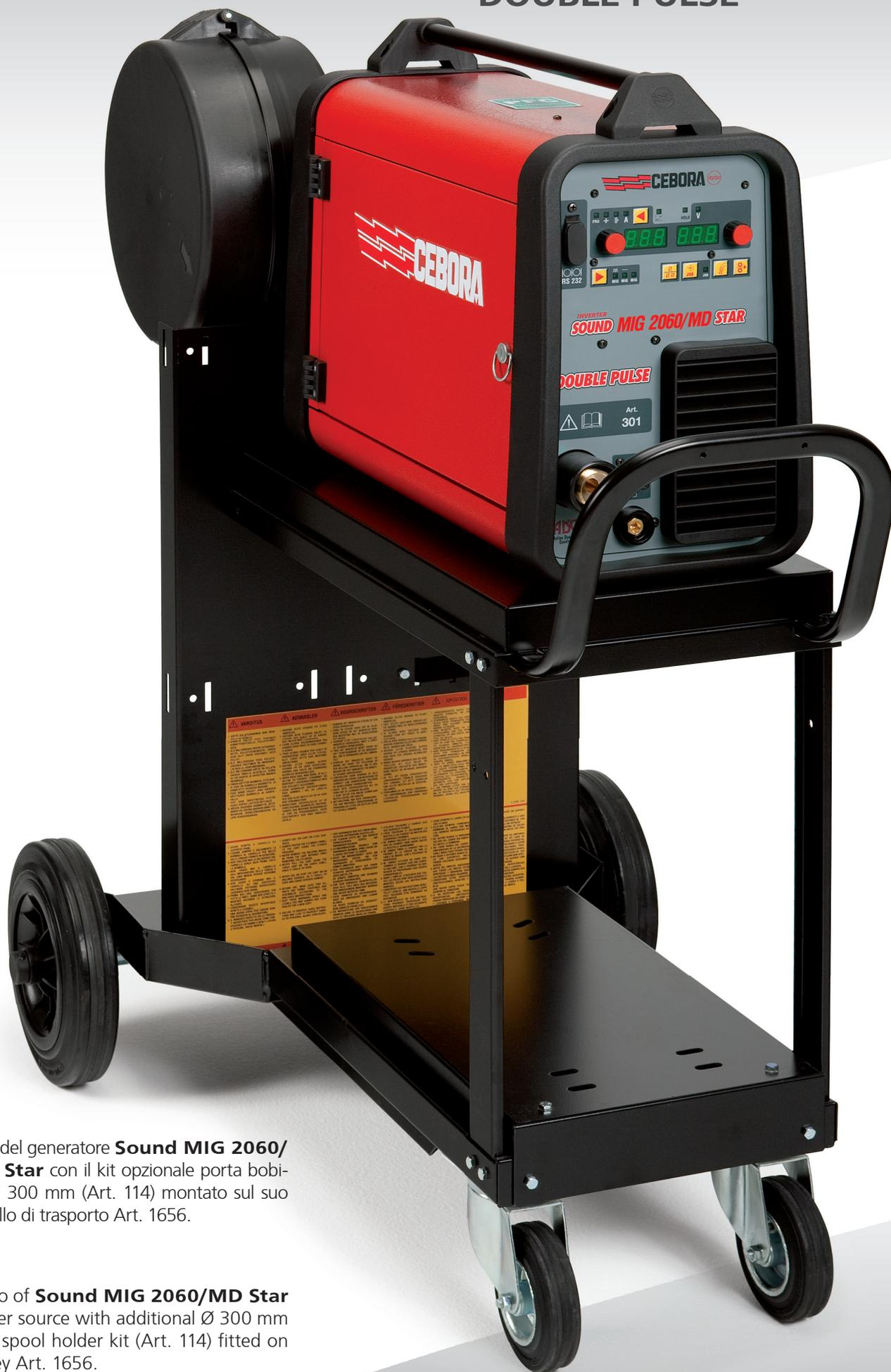
Foto del generatore **Sound MIG 2060/MD Star** con il kit opzionale porta bobina Ø 300 mm (Art. 114) montato sul suo carrello di trasporto Art. 1656.
