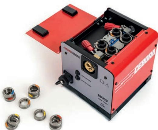
Il software di controllo del processo COLD WIRE disponibile nei WIN TIG permette di gestire l'avanzamento del filo in maniera **indipendente** oppure **sincronizzata** con la corrente di saldatura, anche in modalità Pulsata.
