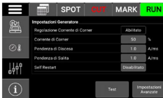
Con l'aggiunta del kit opzionale **interfaccia CNC estesa** (art.425) è possibile regolare da CNC in tempo reale la corrente di corner tramite un segnale analogico dedicato (0-10) Vdc.
