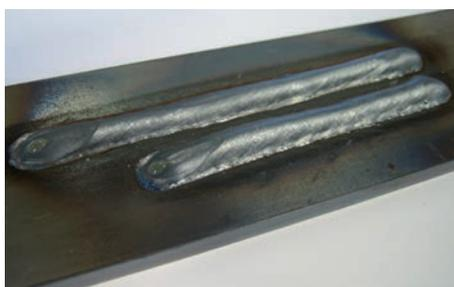
Processo **HD (High Deposit)**, disponibile sia in cortocircuito (standard) che pulsato (opzionale), permette di eseguire saldature con **velocità** di avanzamento molto elevate per offrire **rendimenti** degli impianti sempre maggiori. Consente inoltre di eseguire saldature dove lo spazio a disposizione obbliga ad operare con stick-out molto lunghi.
