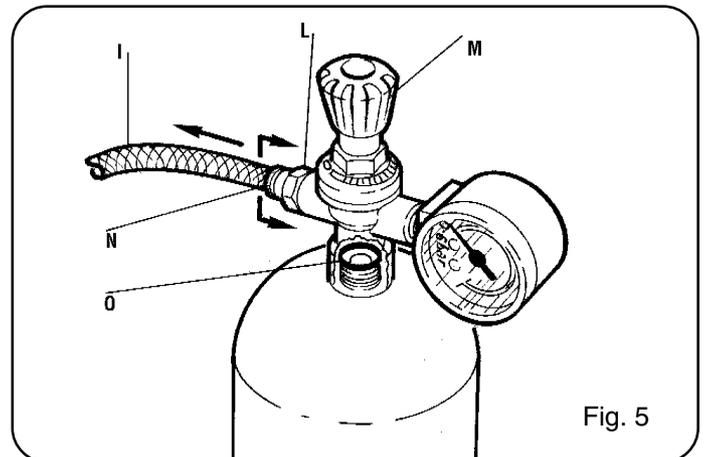
Atornillar la bombona al medidor de flujo y ajustar solo con las manos. Introducir a fondo el tubo de gas (I) el acople (L) del medidor de flujo.
