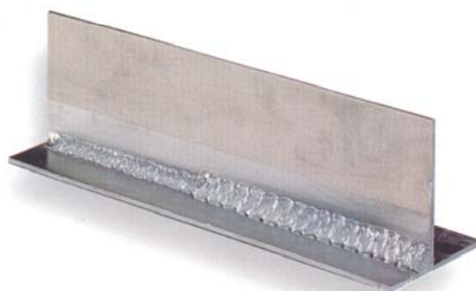
Piano frontale su alluminio Aluminium fillet welding Flachnahtschweißung auf Aluminium Soudure d'angle horizontale sur aluminium Superficie frontal en aluminio
