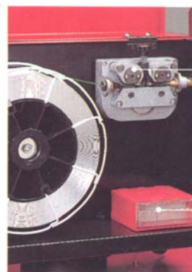
Carrello trainafilo separato • Separate wire feed unit • Separate Drahtvorschubeinheit • Dévidoir mobile Carro de arrastre del hilo separado
