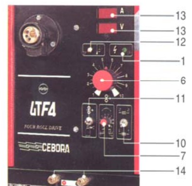
Carrello trainafilo separato • Separate wire feed unit • Separate Drahtvorschubeinheit • Dévidoir mobile Carro de arrastre del hilo separado
