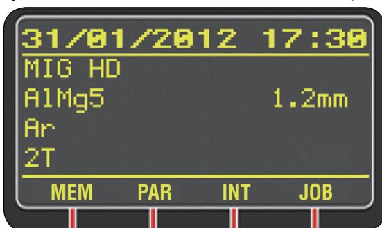
Los parámetros del programa se cambian utilizando el normal proceso de edición, T7 (PAR).
