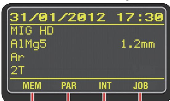
I parametri del programma sono modificabili con la normale procedura di modifica, **T7 (PAR)**.
