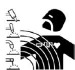
essere dannosi. La corrente elettrica che attraversa qualsiasi conduttore produce dei campi elettromagnetici (EMF). La corrente di saldatura o di taglio genera campi elettromagnetici attorno ai cavi ed ai generatori.
