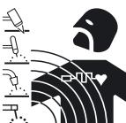
· A corrente eléctrica que atravessa qualquer condutor produz campos electromagnéticos (EMF). A corrente de soldadura, ou de corte, gera campos electromagnéticos em redor dos cabos e dos geradores.
