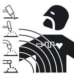
• La corrente elettrica che attraversa qualsiasi conduttore produce dei campi elettromagnetici (EMF). La corrente di saldatura o di taglio genera di campi elettromagnetici attorno ai cavi e ai generatori.
