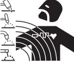
• La corriente eléctrica que atraviesa cualquier conductor produce campos electromagnéticos(EMF). La corriente de soldadura o de corte genera campos electromagnéticos alrededor de los cables y generadores.
