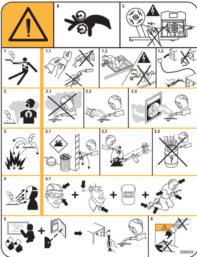
2.2 Maak gebruik van een geforceerd ventilatieof afzuigstelsysteem om de dampen te verwijderen.
