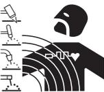
· Der elektrische Strom, der durch einen beliebigen Leiter fließt, erzeugt elektromagnetische Felder (EMF). Der Schweiß- oder Schneidstrom erzeugt elektromagnetische Felder um die Kabel und die Stromquellen.
