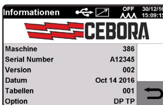
Beim Einschalten der Maschine zeigt das Display für einige Sekunden die Artikelnummer der Maschine, die Seriennummer, die Firmware-Version, das Entwicklungsdatum der Firmware, die Versionsnummer der Tabelle der Synergiekurven und die Optionen für die Stromquelle an.
