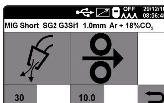
Presionando el botón (test gas) el gas sale por la antorcha por un lapso, que se regula seleccionando el botón **30** y regulando su valor mediante el mando **2**, entre 1 y 60 segundos. Para interrumpir la salida del gas presionar nuevamente el botón .
