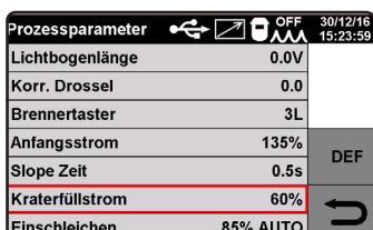
Durch Drücken der Taste **DEF** kann man die Parameter wieder auf die werkseitige Einstellung zurücksetzen.
