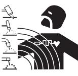
· La corrente elettrica che attraversa qualsiasi conduttore produce dei campi elettromagnetici (EMF). La corrente di saldatura o di taglio genera campi elettromagnetici attorno ai cavi e ai generatori.
