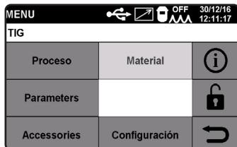
**Proceso** **ELECCIÓN DEL TIPO DE PROCESO DE SOLDADURA, MIG, TIG o MMA** (véase explicación en el capítulo del **Proceso MIG**).
