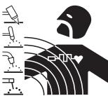
• De elektrische stroom die door een willekeurige conductor stroomt produceert elektromagnetische velden (EMF). De las-/ofsnijstroom produceert elektromagnetische velden rondom de kabels en de generatoren.
