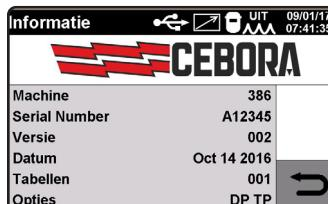
Bij de inschakeling van de machine toont het display een aantal seconden het artikelnummer van de machine, het serienummer, de versie en de ontwikkelingsdatum van de Firmware, het release-nummer van de synergetische curven en de opties van de generator.
