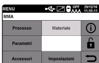
**Processo** **SCELTA DEL TIPO DI PROCESSO DI SALDATURA, MIG, TIG o MMA** (vedi spiegazione dentro il capitolo del **Processo MIG**).
