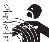
• Strøm, der løber igennem en leder, skaber elektromagnetiske felter (EMF). Svejse- og skærestrøm skaber elektromagnetiske felter omkring kabler og strømkilder.
