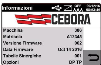
All'accensione della macchina il display, per qualche istante, visualizza: il numero di articolo della macchina, il numero di matricola, la versione del Firmware, la data di sviluppo del Firmware, il numero di release della tabella delle curve sinergiche e le opzioni legate al generatore.
