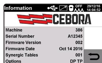
När apparaten startas visar displayen en kort stund följande: Apparatens artikelnummer och serienummer, programvarans version och utgivningsdatum, utgåvenumret för tabellen med de synergiska kurvorna och tillvalen som är förknippade med generatorn.
