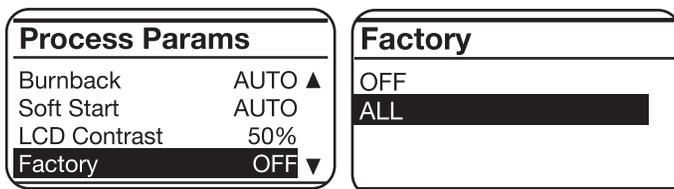
**NB.** Van de functies die u met een balk kunt instellen, kunt u de oorspronkelijke waarde (**default**) herstellen. Dit is uitsluitend mogelijk als op het display **A** de balk wordt weergegeven en u de draaiknop **B** minstens 2 seconden lang indrukt. (Arc Length - Spot Time - Pause Time -3L- HSA - CRA - Inductance, Burnback – Soft Start - Pre Gas - Post Gas - LCD Contrast).
