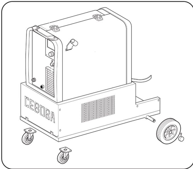
Plaats het lasapparaat op dergelijke wijze dat de lucht vrijuit in het apparaat kan circuleren. Vermijd zoveel mogelijk dat metaalstof of andere voorwerpen in het apparaat terechtkomen.
