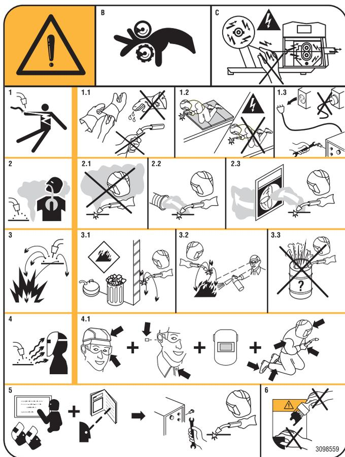
1. De elektrische schokken die door de laselektrode of de kabel veroorzaakt worden, kunnen dodelijk zijn. Zorg voor voldoende bescherming tegen elektrische schokken.
