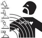
• La corriente eléctrica que atraviesa cualquier conductor produce campos electromagnéticos (EMF). La corriente de soldadura o de corte genera campos electromagnéticos alrededor de los cables y generadores.
