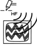
• De hoge frequentie (H.F.) kan radiobesturing, beveiligingen, computers en over het algemeen alle communicatieapparatuur storen
