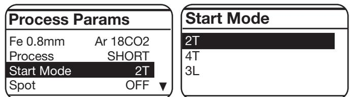
Modo **3L**, especialmente indicado para a soldadura de alumínio.
