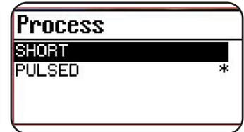
Selecteer of bevestig het type lassen door met behulp van de draaiknop **B** **Short** of **Pulsed** te selecteren en de draaiknop vervolgens minstens 2 seconden lang in te drukken.
