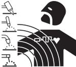
• Strøm, der løber igennem en leder, skaber elektromagnetiske felter (EMF). Svejs- og skærestrøm skaber elektromagnetiske felter omkring kabler og strømkilder.
