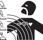
· Le courant électrique traversant n'importe quel conducteur produit des champs électromagnétiques (EMF). Le courant de soudure ou de découpe produisent des champs électromagnétiques autour des câbles ou des générateurs.
