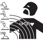
• De elektrische stroom die door een willekeurige conductor stroomt produceert elektromagnetische velden (EMF). De las- of snijstroom produceert elektromagnetische velden rondom de kabels en de generatoren.
