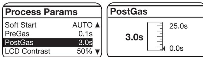
Einstellbereich: 0 bis 25 Sekunden. Diese Funktion dient zum Einstellen der Helligkeit des Displays **A**. Zum Aufrufen der Funktion muss man sie mit dem Regler **B** markieren und dann den Regler kürzer als 2 Sekunden niederdrücken. Auf dem Display **A** erscheint dann der Einstellbalken zum Ändern des Werts. Zum Bestätigen den Regler **B** mindestens 2 Sekunden niederdrücken.
