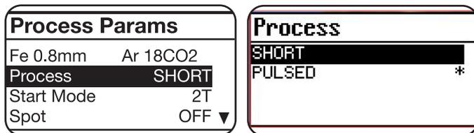
Para seleccionar ou confirmar o tipo de soldadura, é necessário, por meio do botão **B**, seleccionar e premir,
