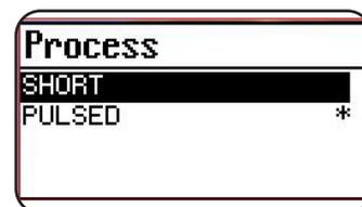
Per scegliere o confermare il tipo di saldatura, è necessario, tramite la manopola **B**, selezionare e premere, per almeno 2 secondi su Short o Pulsed.
