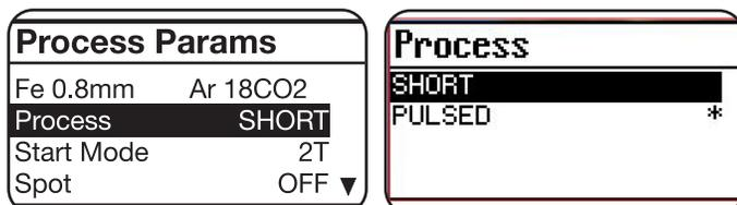
Para elegir o confirmar el tipo de soldadura, es necesario, mediante la empuñadura **B**, seleccionar y presionar, por al menos 2 segundos **Short** o **Pulsed**.
