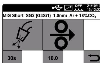
Lorsque l'on appuie sur la touche (test de gaz) le gaz sort de la torche pendant un laps de temps qui est réglé au moyen de la touche **30** et dont la valeur réglée au moyen du bouton rotatif **2** varie de 1 à 60 secondes. Pour interrompre la sortie du gaz appuyer de nouveau sur la touche .
