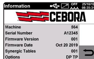
Näytöllä näkyy: koneen tuotenumero ja sarjanumero, laitteisto-ohjelmaversio ja laitteisto-ohjelman valmistuspäivämäärä, synergiajäyrien taulukon julkaisunumero ja asennetut lisävalinnat.
