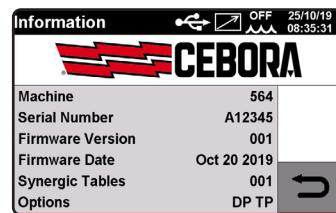
Displayet viser: Maskinens artikelnr., serienummer, firmwareversion, dato for firmwarens udgivelse, udgavenummeret for tabellen med de synergiske kurver og det installerede tilbehør.
