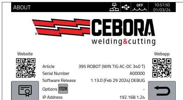
Lors de sa mise sous tension, l'écran affiche pendant quelques secondes toutes les informations concernant l'article de la machine, le numéro de série, la version du logiciel, la date de sortie du logiciel, les options installées et l'adresse IP.
