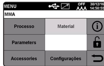
**Processo ESCOLHA DO TIPO DE PROCESSO DE SOLDADURA, MIG, TIG ou MMA** (vedi spiegazione dentro il capitolo del **Processo MIG**).
