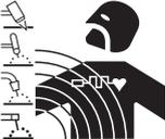
• När elektrisk ström passerar genom en ledare alstras elektromagnetiska fält (EMF). Svets- eller skärströmmen alstrar elektromagnetiska fält runt kablar och generatorer.
