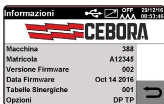
All'accensione della macchina il display, per qualche istante, visualizza: il numero di articolo della macchina, il numero di matricola, la versione del Firmware, la data di sviluppo del Firmware, il numero di re-
