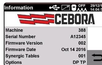
Kun käynnistät koneen, ytimelle ilmaantuvat hetkeksi seuraavat tiedot: koneen tuotenumero ja sarjanumero, laitteisto-ohjelmistoversio ja laitteisto-ohjelman valmistuspäivämäärä, synergia-käyrien taulukon julkaisunumero ja virtalähteeseen liittyvät toiminnot. Samat tiedot toistuvat myös valikon sisällä.
