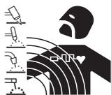
• Der elektrische Strom, der durch einen beliebigen Leiter fließt, erzeugt elektromagnetische Felder (EMF). Der Schweiß- oder Schneidstrom erzeugt elektromagnetische Felder um die Kabel und die Stromquellen.
