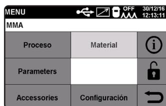
**Proceso** **ELECCIÓN DEL TIPO DE PROCESO DE SOLDADURA, MIG, TIG o MMA** (véase explicación en el capítulo del **Proceso MIG**).
