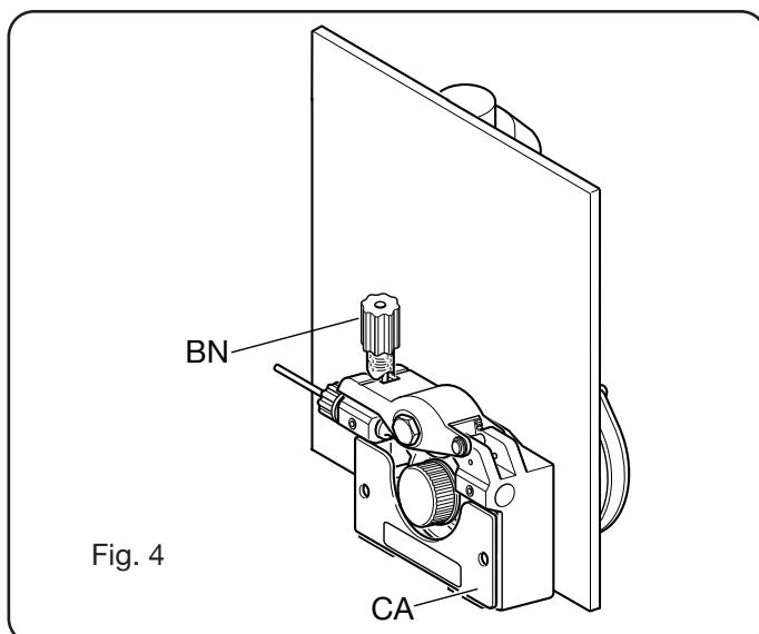
Monter la bobine du fil et insérer le fil dans le dispositif d'entraînement-fil et dans la gaine de la torche.
