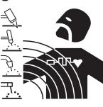
• Le courant électrique traversant n'importe quel conducteur produit des champs électromagnétiques (EMF). Le courant de soudure ou de découpe produisent des champs électromagnétiques autour des câbles ou des générateurs.
