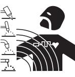
• La corriente eléctrica que atraviesa cualquier conductor produce campos electromagnéticos (EMF). La corriente de soldadura o de corte genera campos electromagnéticos alrededor de los cables y generadores.
