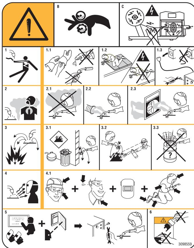
1. Les décharges électriques provoquées par l'électrode de soudage ou le câble peuvent être mortelles. Se protéger de manière adéquate contre les décharges électriques.
