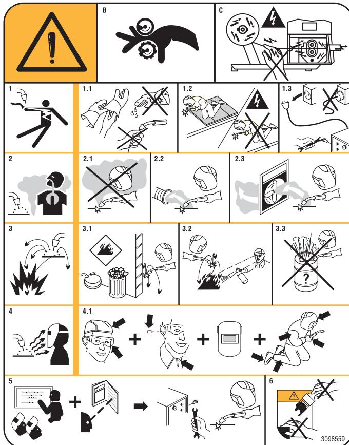
1. Hitsauselektrodiin tai kaapelin aiheuttamat sähköiskut saattavat johtaa kuolemaan. Suojaudu sähköiskuille asianmukaisella tavalla.
