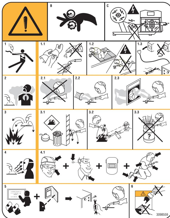
1. Von der Schweißelektrode oder vom Kabel verursachte Stromschläge können tödlich sein. Für einen angemessenen Schutz gegen Stromschläge sorgen.
