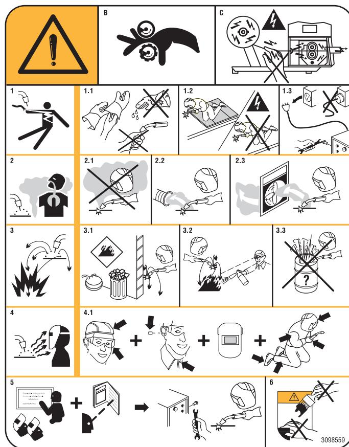
1. Los choques eléctricos provocados por el electrodo de soldadura o el cable pueden ser letales. Protegerse adecuadamente contra el riesgo de choques eléctricos.
