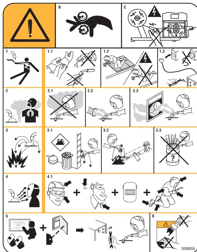
1. Elektriske stød frembragt af svejseelektroden eller kablet kan være dødelige. Beskyt dig mod elektrisk stød på passende vis.
