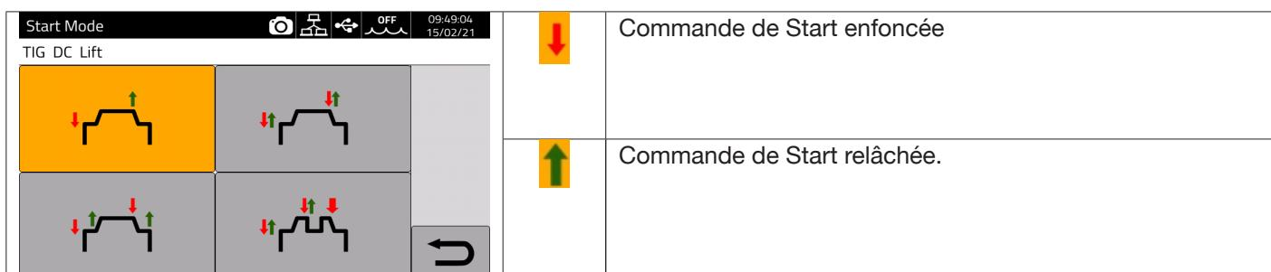
Le bouton **START** pour les applications de type manuel est présent sur le connecteur de commande à distance du dévidoir.
