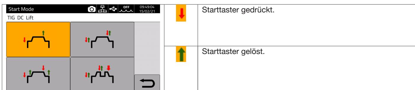
Das **START**-Steuersignal für manuelle Anwendungen liegt an der Steckvorrichtung für Fernregler des Drahtvorschubgeräts an.
