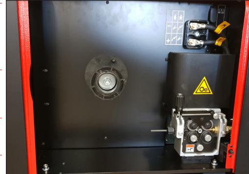
Photo compartiment bobine avec dévidoir à 4-rouleaux
