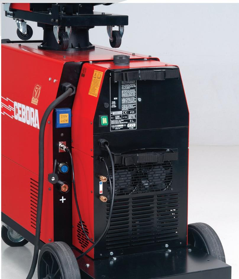
Les machines EVO SYNERGIC Art. 643 et 647 peuvent être utilisées avec les torches MIG refroidies par air. Pour des utilisations plus intensives, il est possible d'installer sur la machine le groupe de refroidissement modulaire en option (Art. 1680) qui permet d'utiliser les torches MIG refroidies par eau.
