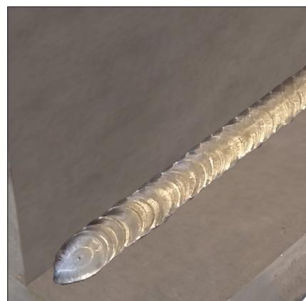
Arc pulsé à très haute fréquence pour arc de soudage plus concentré
