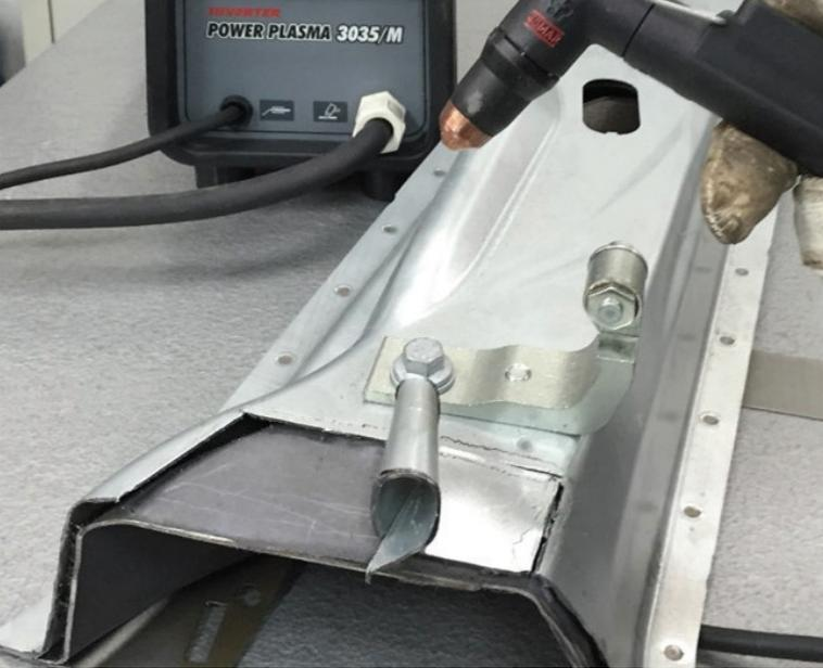
Générateurs à onduleur pour le coupage plasma à air comprimé. Grande maniabilité et confort d'utilisation pour des coupages d'excellente qualité sur tous les métaux, y compris les nouveaux aciers à haute résistance. Technologie Cebora « double skin ».
