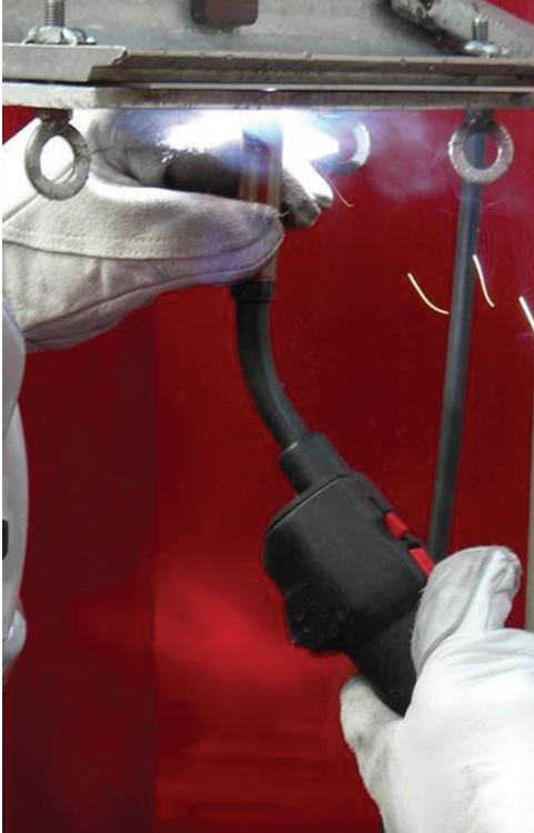
Postes à souder à onduleur synergiques MIG-MAG, pouvant souder en court-circuit, pulsé, double pulsé, ayant de nombreuses autres fonctions comme l'amorçage Hot Start et le remplissage du cratère en fin de cordon. Ils offrent jusqu'à 70 programmes synergiques de soudage. Ils peuvent être équipés de torches standard MIG-MAG ou de torches push-pull de 4 m.
