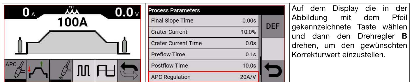
Der Korrekturwert kann im Hauptbildschirm oder im Menü der **Prozessparameter** eingestellt werden: **Taste Z -> APC Regulation**
