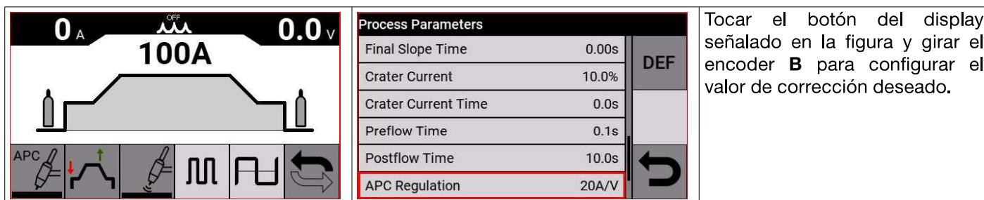
El valor de corrección puede ser configurado en la pantalla principal o en el menú de los **Parámetros de proceso: Botón Z -> APC Regulation**
