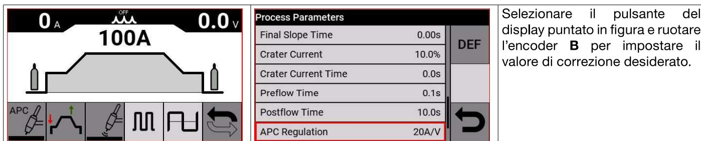
Il valore di correzione può essere impostato dalla schermata principale oppure nel menù dei **Parametri di processo: Tasto Z -> APC Regulation**
