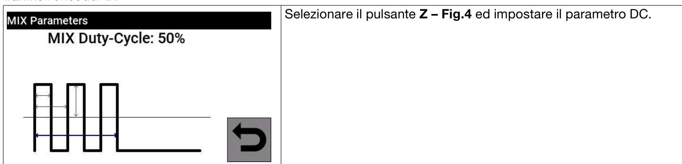
Settando il parametro Mix Duty-Cycle si definisce la percentuale di corrente continua di penetrazione all'interno del periodo di saldatura **AC**.
