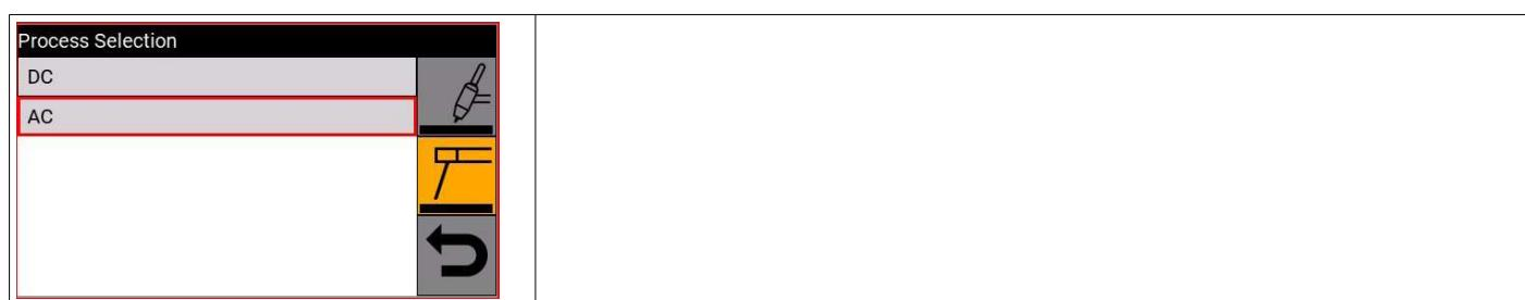
Nel processo MMA AC la frequenza della corrente di uscita è di 50Hz e la forma d'onda di uscita è quadra quadra. Frequenza e forma d'onda sono fissi e non variabili a differenza del processo TIG AC.
