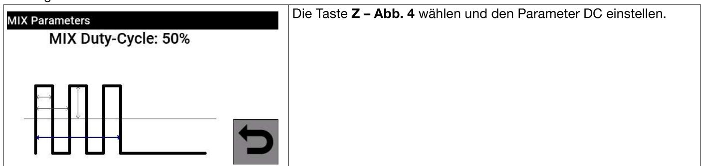
Mit dem Parameter Mix Duty-Cycle legt man den Prozentanteil des Gleichstroms für den Einbrand innerhalb der Wechselstromperiode **AC** zum Schweißen fest.
