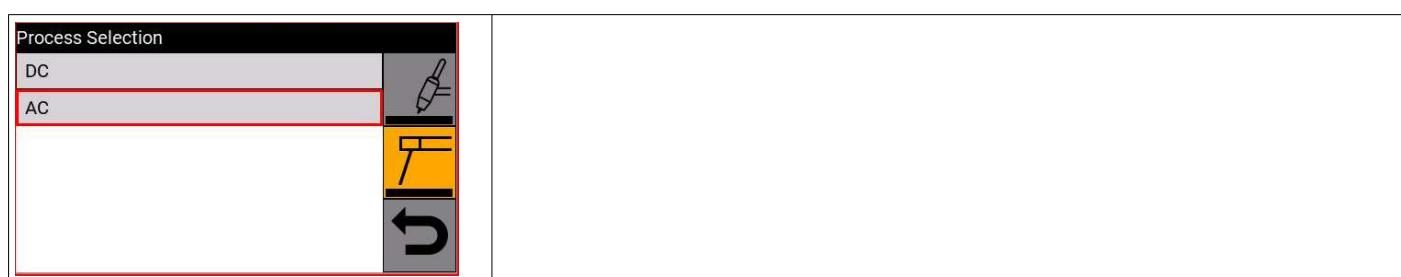
Dans le procédé MMA AC, la fréquence du courant de sortie est de 50 Hz et la forme d'onde de sortie est carrée. La fréquence et la forme d'onde sont fixes et non variables, contrairement au procédé TIG AC.
