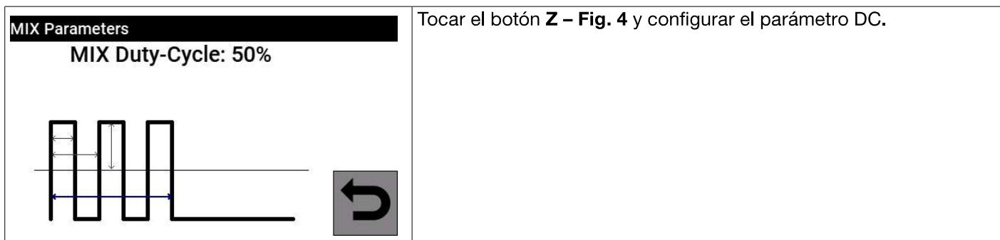
Configurando el parámetro Mix Duty-Cycle se define el porcentaje de corriente continua de penetración dentro del período de soldadura **AC**.
