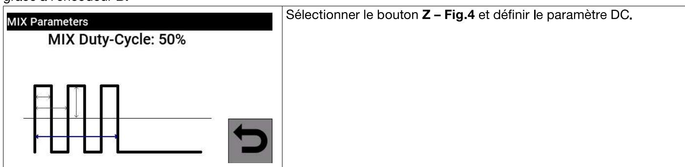
Le réglage du paramètre Mix Duty-Cycle permet de définir le pourcentage de courant continu de pénétration pendant la période de soudage **AC**.
