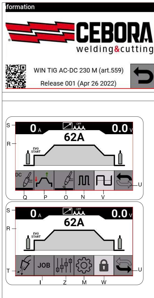
Lors de sa mise sous tension, l'écran affiche pendant quelques secondes toutes les informations concernant l'article de la machine, le numéro de série, la version du logiciel et la date de la mise à jour du logiciel.
