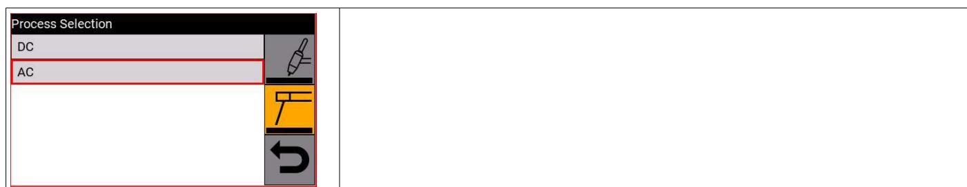
Beim Prozess MMA AC beträgt die Frequenz des Stroms am Ausgang 50Hz und die Wellenform ist die einer Rechteckwelle.
