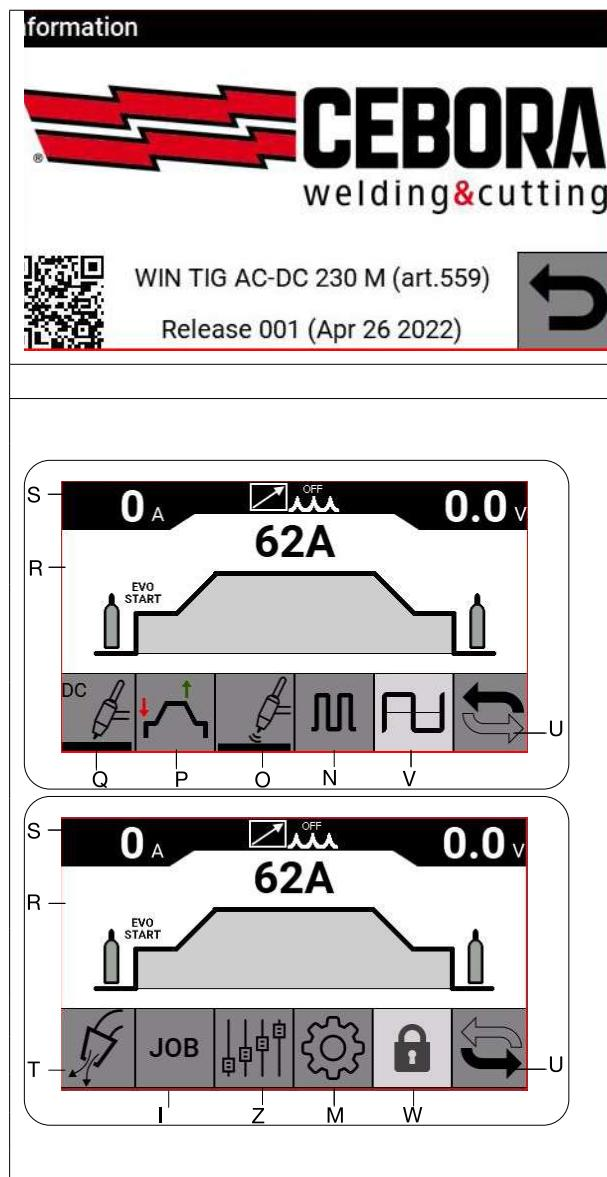
Nach dem Einschalten zeigt das Display für einige Sekunden die folgenden Informationen an: Artikelnummer des Geräts, Seriennummer, Softwareversion und Datum der Aktualisierung der Software.
