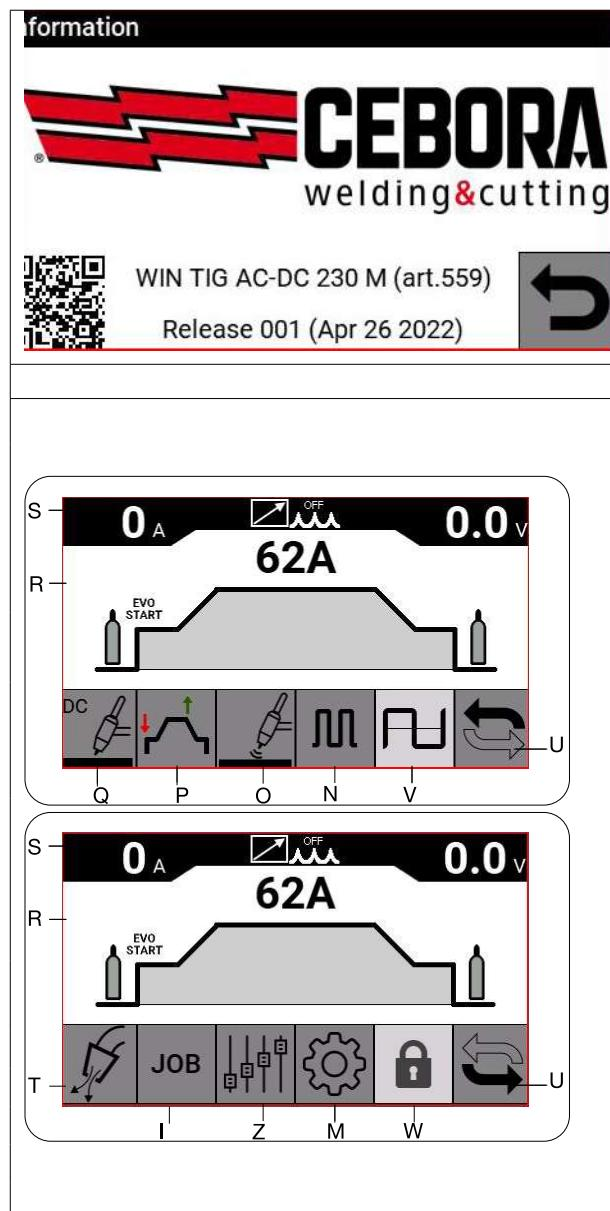
Al encendido, el display visualiza durante unos segundos todos los datos concernientes al artículo de la máquina, la matrícula, la versión del software y la fecha de actualización software. Sucesivamente, en el display aparece la pantalla principal con la configuración de fábrica
