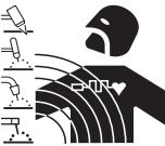
· A corrente eléctrica que atravessa qualquer condutor produz campos electromagnéticos (EMF). A corrente de soldadura, ou de corte, gera campos electromagnéticos em redor dos cabos e dos geradores. Os campos magnéticos derivados de correntes elevadas podem influenciar o funcionamento de pacemakers. Os portadores de aparelhos electrónicos vitais (pacemakers) devem consultar o médico antes de se aproximarem de operações de soldadura por arco, de corte, desbaste ou de soldadura por pontos.
