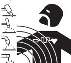
• De elektrische stroom die door een willekeurige conductor stroomt produceert elektromagnetische velden (EMF). De las-/snijstroom produceert elektromagnetische velden rondom de kabels en de generatoren.
