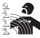
• La corriente eléctrica que atraviesa cualquier conductor produce campos electromagnéticos(EMF). La corriente de soldadura o de corte genera campos electromagnéticos alrededor de los cables y generadores.
