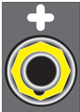
Met deze aansluiting moet de losse laskabelkoppeling van de tussenkabel worden verbonden (positieve pool (+)).
