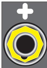
Til denne kabelbøsning skal mellemkablets fritliggende stik forbindes (+ pol).
