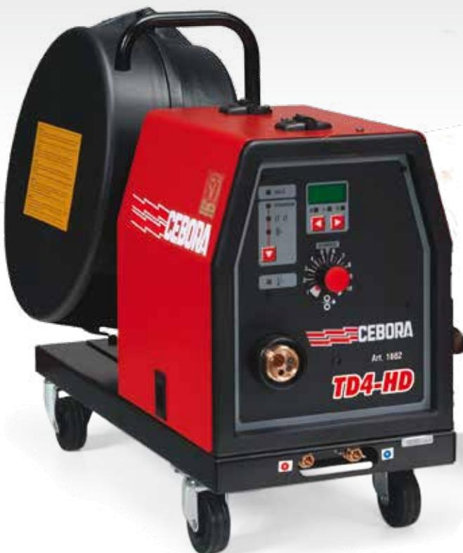
Los generadores de la gama EVO Synergic con carro arrastrahilo separado utilizan el carro Cebora TD4-HD de 4 rodillos ø 40 (art. 1662) con la posibilidad de activar la selección del programa sinérgico de soldadura requerido, la función 2T (manual) / 4T (automática) y la función test hilo.
