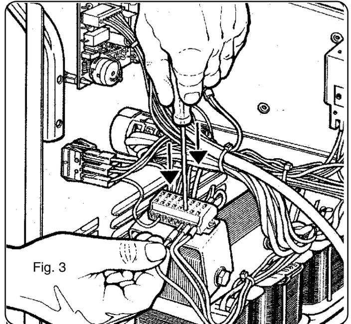
Prima di collegare il cavo di alimentazione (16) assicurarsi che la tensione di rete corrisponda a quella della saldatrice, quindi:
