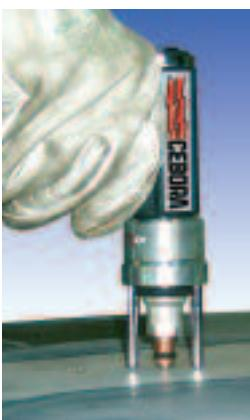
Es esencial, en efecto, que el espárrago se pueda mantener en constante tracción, mientras el operador procede, con ambas manos libres, a las necesarias operaciones intermedias y de apisonado de la chapa; el dispositivo mecánico de desenganche permite, por tanto, descargar el espárrago.
